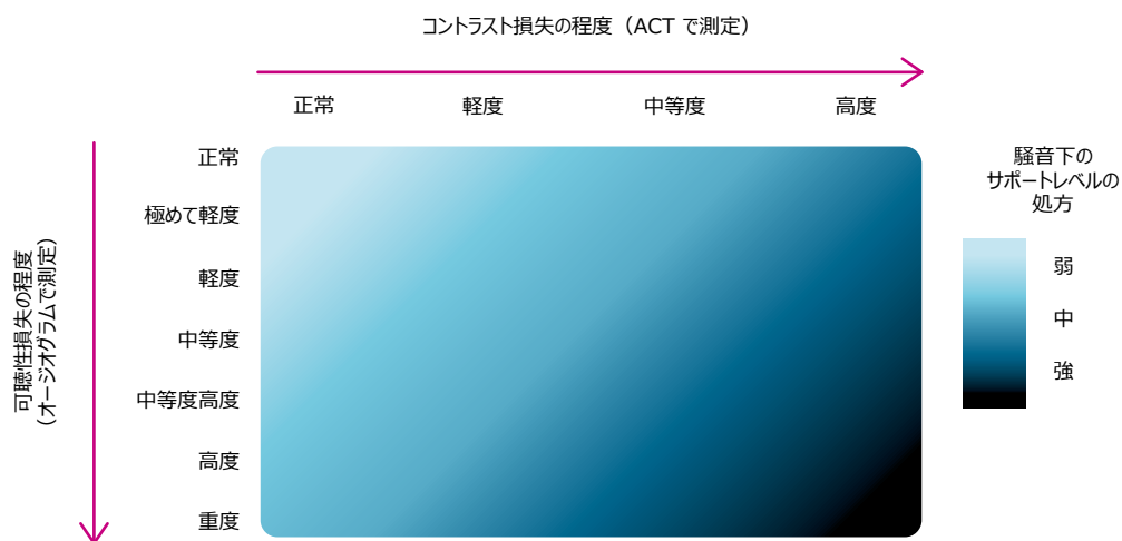
図10:ACTに基づいた処方を使用すると、個々のユーザーに適用される騒音下サポートレベルは、可聴性損失とコントラスト損失の両者の程度によって変化します。
