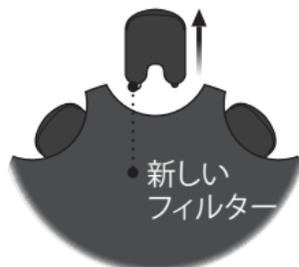
ケースからツールをひとつ取り出します。何もついていない側は古いフィルターの取り外しに使用します。もう片側には交換用の新しいフィルターがついています。
