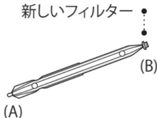
ケースから棒をひとつ取り出してください。棒には(A)と(B)の二つの先端があります。(B)の先端には交換用の新しいOキャップがついています。
